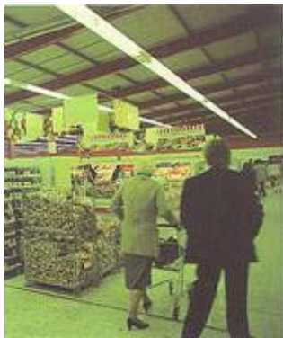
Типичное искажение цветов при использовании обращаемой пленки для дневного света в условиях освещения флюоресцентными лампами
