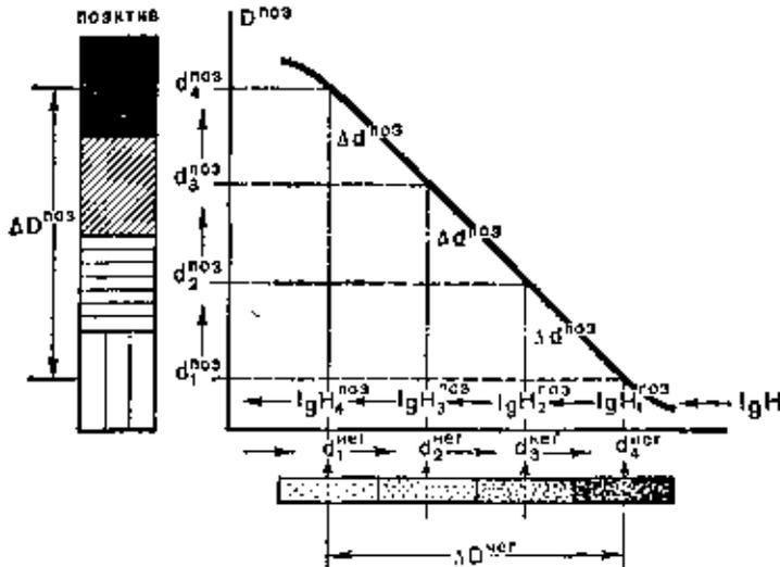
Рис. 58. Построение позитивного изображения в негативно-позитивном процессе
