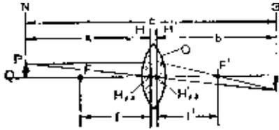
Рис. 64. Ход лучей в проекционном устройстве
