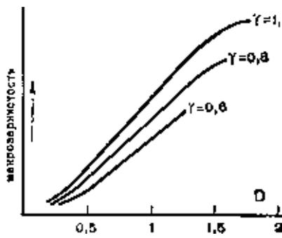
Рис. 28. Схема, поясняющая зависимость макрозернистости от величины  $\gamma$  и  $D$  негатива
