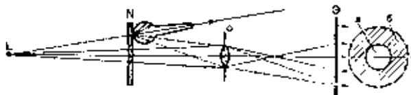
Рис. 68. Схема освещения негатива *N* направленным светом от точечного источника света *L*. Объектив фотоувеличителя *O* создает на экране *Э*
