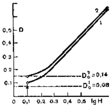
Рис. 22. Схема, иллюстрирующая влияние величины вуали ( $D_0$ ) на передачу деталей негативным изображением. У первого фотоматериала  $D_0^1 = 0,08$ , у второго  $D_0^2 = 0,14$ . Поэтому количество освещения, логарифм которого равен 0,1, на первом фотоматериале даст изображение детали, так как ее почернение превышает плотность вуали; на втором — не даст из-за равенства почернения и вуали
