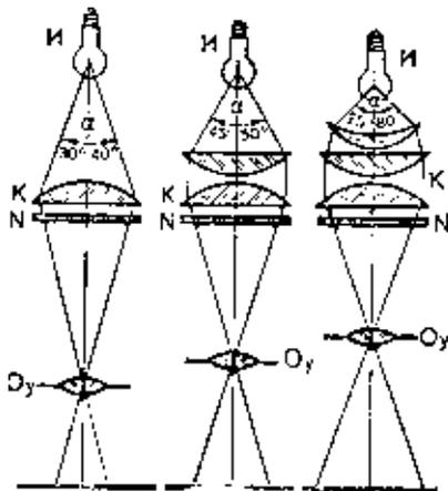
Рис. 72. Величины углов охвата ( $\alpha$ ) у одно-, двух и трехлинзового конденсоров: И — источник света, К — конденсор, N — негатив и O — объектив фотоувеличителя, фокусное расстояние у всех конденсоров разной величины
