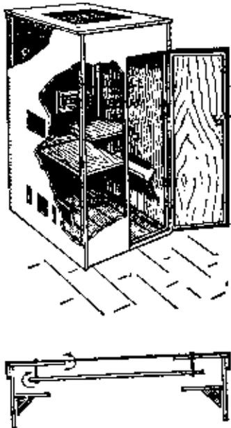
Рис. 1. Фотолаборатория-шкаф. Внизу дана схема вентиляционного устройства
